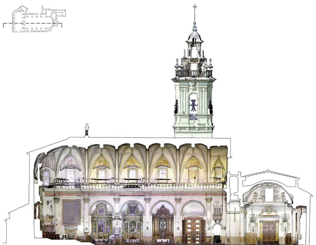
Fig. 2. Levantamiento con escáner láser de la Iglesia de Algemés de Valencia. Sección longitudinal. Fuente: Grupo de investigación LevARQ, Universitat Politècnica de València. Autores: P. Rodríguez-Navarro, T. Gil-Piqueras, A. Pérez-Vila.
