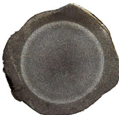
Figura 2. Sección de una barra fabricada mediante el procedimiento TEMPCORE.
