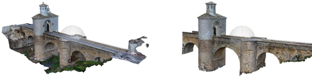
Figura 2. Nube de puntos inicial (a) y final tras proceso de limpieza y downsampling (b)
